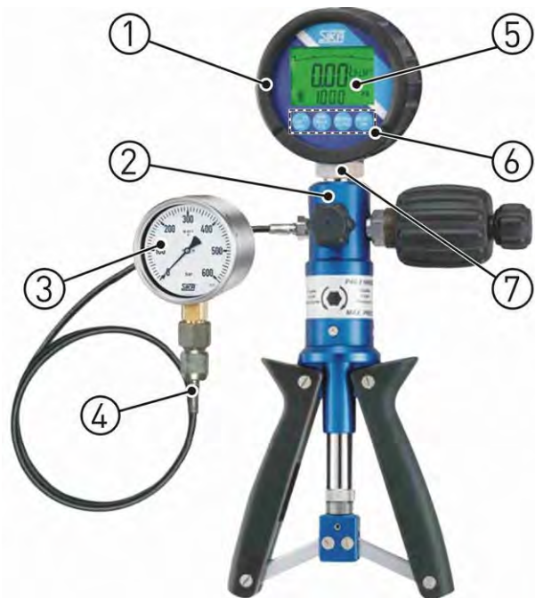
Beispielhafter Messaufbau mit Handpumpe.
