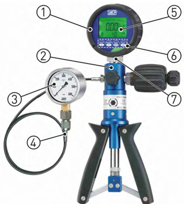
Beispielhafter Messaufbau mit Handpumpe.
